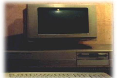
В 1989 году школа приобретает 1 компьютер - Robotron. ОЗУ которого составляло всего 512 Кб. в ПЗУ компьютера был также прошит язык программирования Basic. Жесткий диск компьютера был объемом - 10 Мб.
